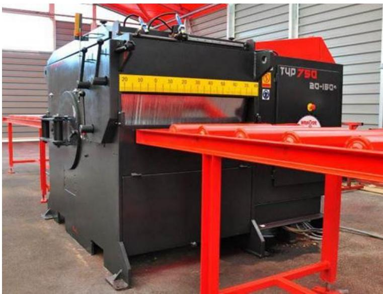
Pentru debitarea cu pierderi minime a prismelor in lamele, WRAVOR a dezvoltat un Ferastrau panglica tip RESAW cu taiere dus-intors, derivat din varianta standard dar cu cateva caracteristici speciale: ghidaje liniare ce asigura o taiere de precizie la viteze mari de lucru, grife speciale de fixare prisme, sistem de racire panza in timpul tajerii, unitate dubla de evacuare rumegus.
