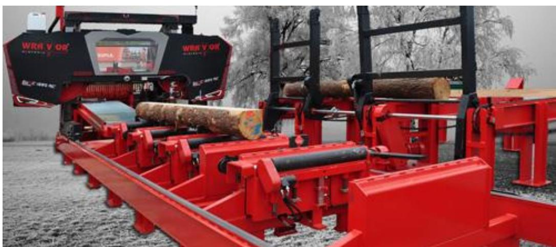
Echipat cu scaun ergonomic, pupitru poate fi pozitionat pe masina sau la distanta, astfel incat sa permita operatorului o vizualizare buna a zonei de incarcare busteni, taiere si evacuare cherestea. Pentru setarea manuala a grosimii de taiere, masina este echipata standard cu sistem senzorial cu disc si rigla gradata, iar pentru taierea in mod automat este dotat cu computer avansat cu memorii si programe speciale.
